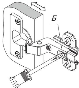
в) Регулирование наложения установочный винт "В" повернуть по или против часовой стрелки, наложение двери соответственно увеличится или уменьшится.
